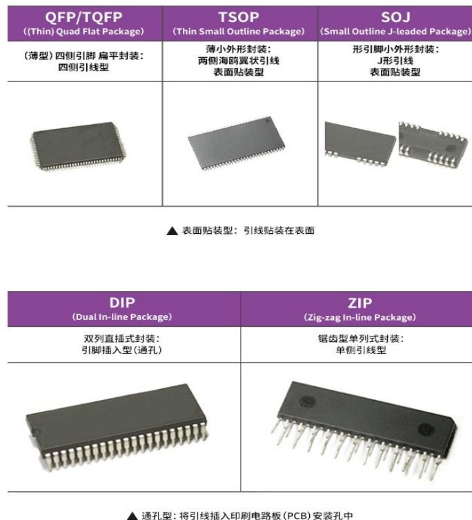
◆ 图：通孔型和表面贴装型的封装形式对比
